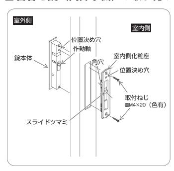
①室内側より室内側化粧座、室外側より錠本体 を取付穴に差し込み、プラスドライバーで取 付ねじをしめる。
