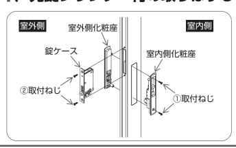
①室内側よりプラスドライバーで室内側化粧座 の取付ねじをはずし、室内側化粧座および室 外側化粧座をはずす。
