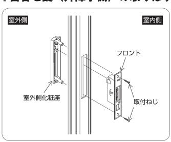
①室内側よりプラスドライバーでフロントの 取付ねじをはずし、フロントおよび室外側 化粧座をはずす。
