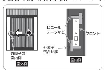
①外障子の召合せ框の室内側に取り付いているフロントの角部にビニールテープなどを使って取り付け位置に印を付ける。
