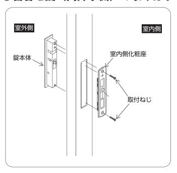
①室内側よりプラスドライバーでし室内側化粧 座の取付ねじをはずし、室内側化粧座および 錠本体をはずす。
