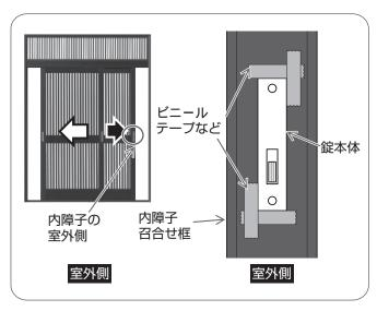
①内障子の召合せ框の室外側に取り付いている 錠本体の角部にビニールテープなどを使って 取り付け位置に印を付ける。
