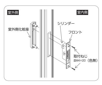
①室内側よりフロント、室外側より室外側化 粧座を取付穴に差し込み、プラスドライ バーで取付ねじをしめる。
