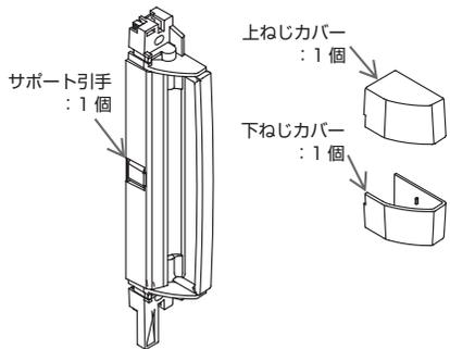
サポート引手 : 1個<br>上ねじカバー : 1個<br>下ねじカバー : 1個 |
