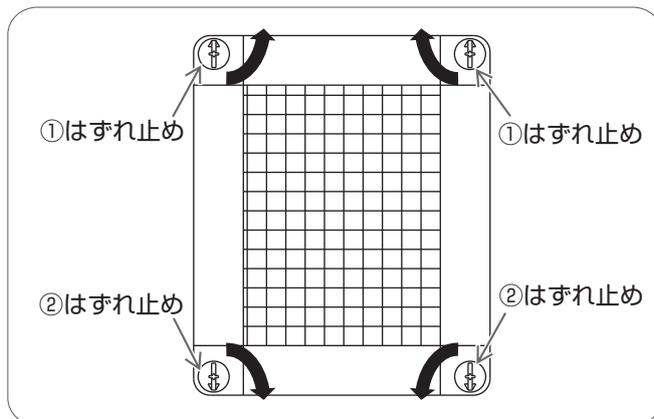
① 網戸を枠に押し当て、プラスドライバーで上の左右にあるはずれ止めのツマミを90度回しツマミの溝をタテにする。
