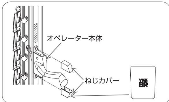
①オペレーター本体にねじカバーを取り付ける。
