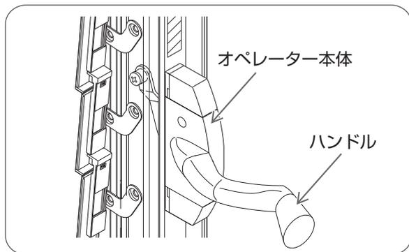
①窓の全開・全閉のハンドルの向きを変える場合、プラスドライバーで止めねじをゆるめ、ハンドルを抜いて向きを調整し、再度止めねじをしめる。
