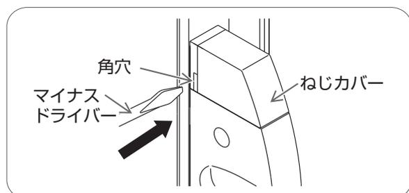
①マイナスドライバーを角穴に差し込み、上下のねじカバーをはずす。
