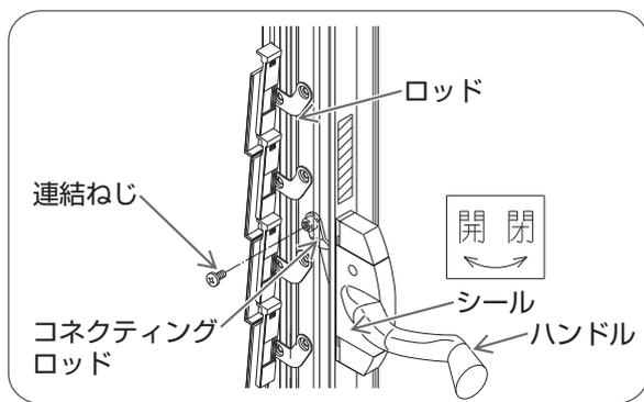
①ハンドルを操作し、コネクティングロッドとロッドを合わせ、プラスドライバーで連結ねじをしめる。
