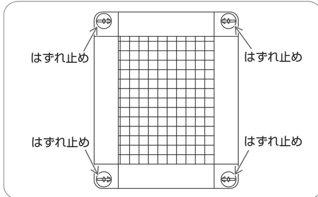
① 網戸の上下左右（4ヶ所）のはずれ止めのツマミの溝がヨコになり、網戸から引寄せ片が出ていない（解除状態）ことを確認する。
