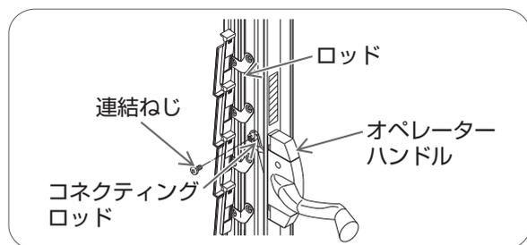
①プラスドライバーでコネクティングロッドとロッドの連結ねじをはずす。
