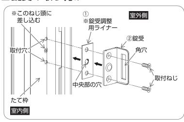
①錠受調整用ライナーの中央部の穴を たて枠のねじ頭に差し込み、たて 枠の取付穴に合わせる。
