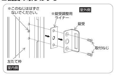
①プラスドライバーで錠受の取付ねじ をはずし、錠受および錠受調整用ラ イナーをはずす。
