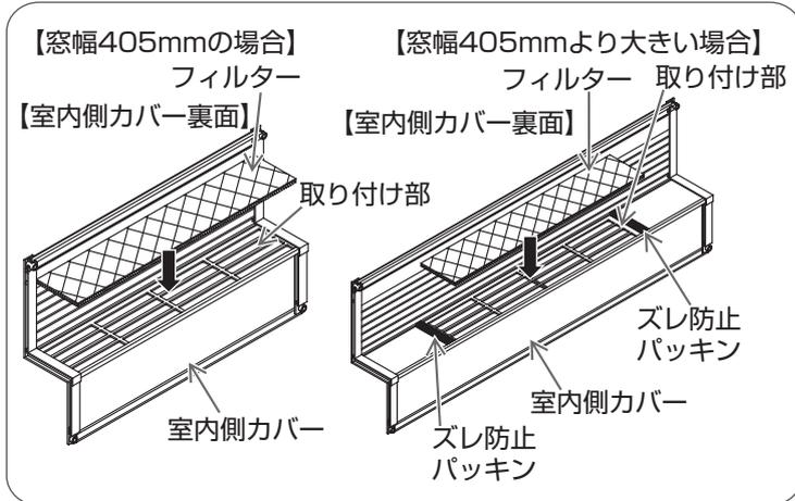
①フィルターを室内側カバー裏面の取り付け部に取り付ける。
