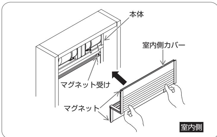
①室内側カバーの下部両端を両手で持ち、室内側より室内側カバー裏面にあるマグネット（4隅）と本体のマグネット受け（4隅）の位置を合わせ（上記2項目参照）、室内側カバーを本体に取り付ける。
