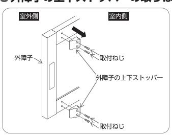
①室内側よりプラスドライバーで外障子の上下ストッパーの取付ねじをはずし、外障子の上下ストッパーをはずす。
