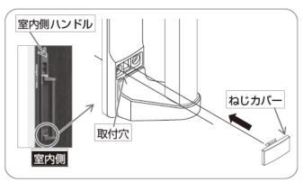
①室内側より室内側ハンドルの取付穴にねじカ バーを取り付ける。
