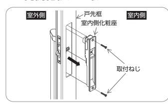
①室内側よりプラスドライバーで室内側化粧 座の取付ねじをはずし、室内側化粧座をはず す。
