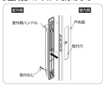
①室外側よりプラスドライバーで室外側ハンドルの取付ねじをはずし、室外側ハンドルをはずす。
