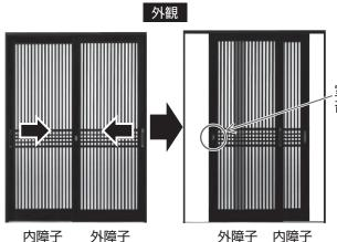
①外障子と内障子を行き違えて室外側障子の 召合わせ面の召合せ錠受を見えるようにす る。
