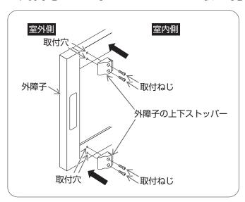
①室内側より外障子の上下ストッパーをそれぞ れ取付穴に合わせ、プラスドライバーで取付 ねじをしめる。
