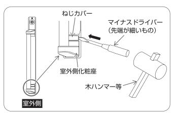
①室外側よりマイナスドライバーをねじカバー と室外側化粧座の溝部に当て、木ハンマーな どでたたき、ねじカバーをはずす。
