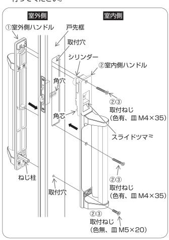
①室外側より室外側ハンドルのねじ柱を取付穴に差し込んで室外側ハンドルを戸先框に合わせる。
