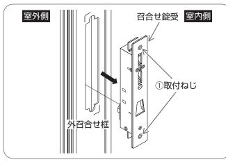
①室内側よりプラスドライバーで召合せ錠受の 取付ねじをいっぱいまでゆるめる。
