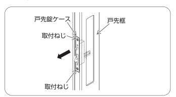
①プラスドライバーで戸先錠ケースの取付ね じをはずし、戸先錠ケースをはずす。
