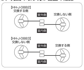
① 交換する戸先錠の取り付け位置を確認する。 (左図参照)
