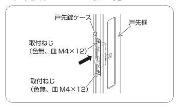
①戸先錠ケースを戸先框の取付穴に差し込み、 プラスドライバーで取付ねじ(色無、皿 M4×12)をしめる。
