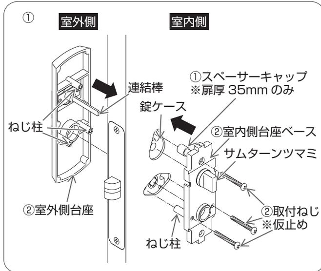
①室内側台座ベースのねじ柱上側にスペーサーキャップを取り付ける。
