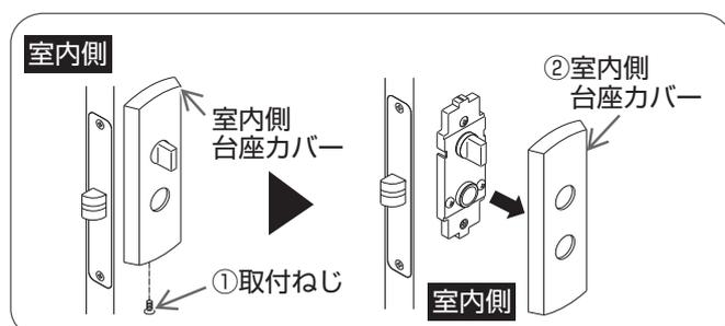
①室内側よりプラスドライバーで室内側台座カバー下側の取付ねじをはずす。(下図参照)
