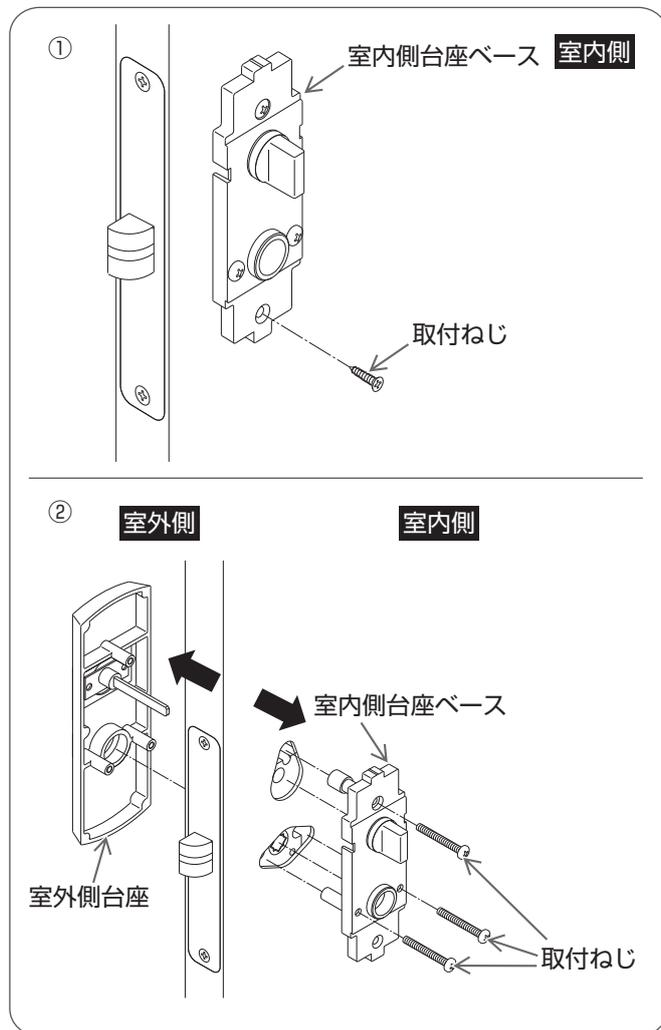
①室内側よりプラスドライバーで室内側台座ベース下側の取付ねじをはずす。
