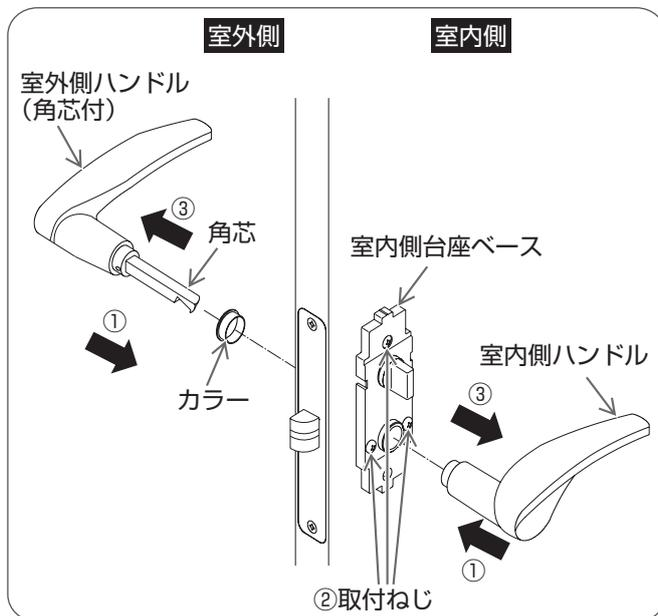
①室外側より室外側ハンドル(角芯付)とカラーを室外側台座に差し込み、室内側より室内側ハンドルを室外側ハンドル(角芯付)の角芯に合わせて差し込む。
